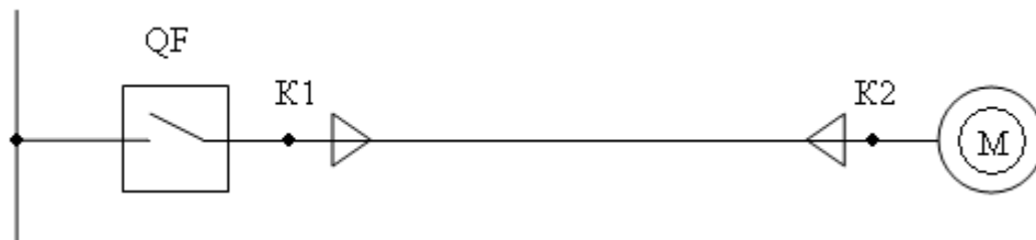
Рисунок 6 - Расчетная схема для определения кратностей коммутационных перенапряжений
