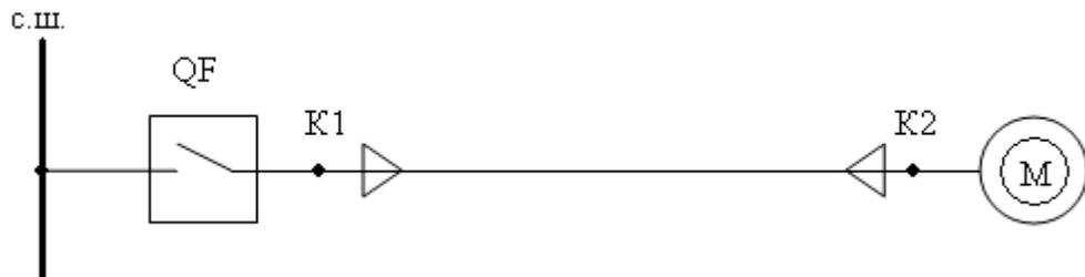
Рисунок 4.5 – Расчетная схема для определения кратностей коммутационных перенапряжений
