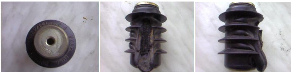
Рисунок 1.5 – Характерный вид термического разрушения ОПН в режиме однофазного замыкания на землю
