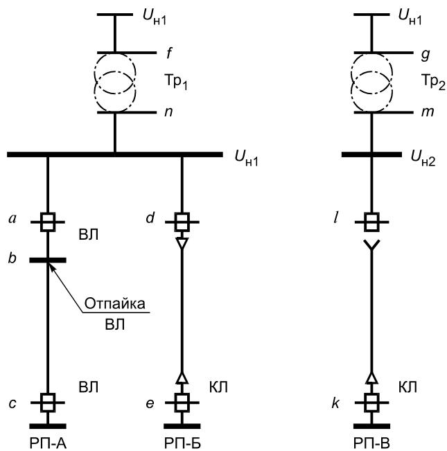
ВЛ — воздушная линия; КЛ — кабельная линия; РП-А, РП-Б, РП-В — распределительные подстанции; Тр<sub>1</sub>, Тр<sub>2</sub> — силовые трансформаторы; U<sub>H1</sub>, U<sub>H2</sub> — напряжения на первичной и вторичной обмотках силового трансформатора; a, b, c, d, e, f, g, k, l, m, n — возможные точки присоединения к электрической сети
