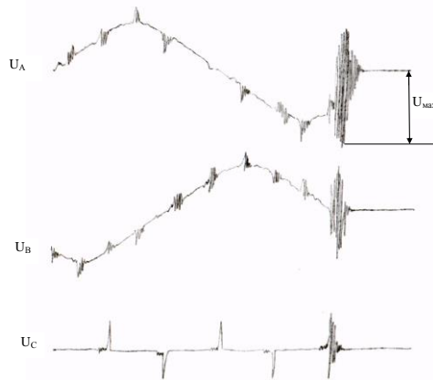
Рис.6 Осциллограммы при отключении синхронного двигателя Р=1200кВт в режиме ОЗЗ вакуумным выключателем ВВ/ТЕL-10-20/1000 У2, при селективной работе защит от ОЗЗ. K_{\max}=2.8 , f=80\text{кГц} .
