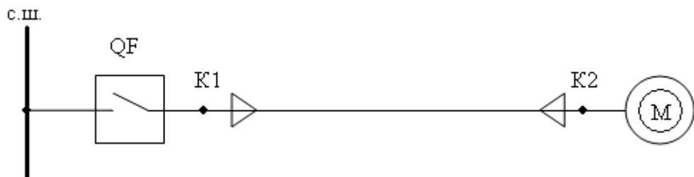
Рисунок 4.11 – Расчетная схема для определения кратностей коммутационных перенапряжений
