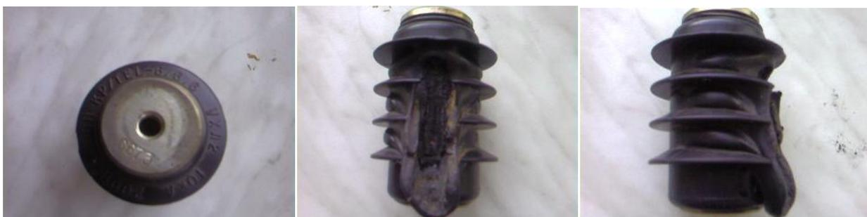
Рисунок 5.6 – Характерный вид термического разрушения ОПН в режиме однофазного замыкания на землю
