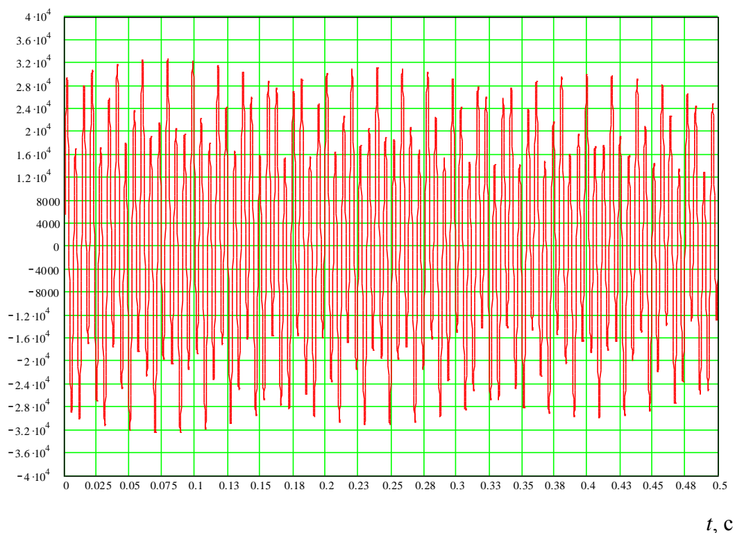
Рисунок П9.2 – Перенапряжения на фазе В секции шин ( \psi = 10^0 , \varphi = 0^0 , I_{\text{ДГР}} = 26,5 А)
