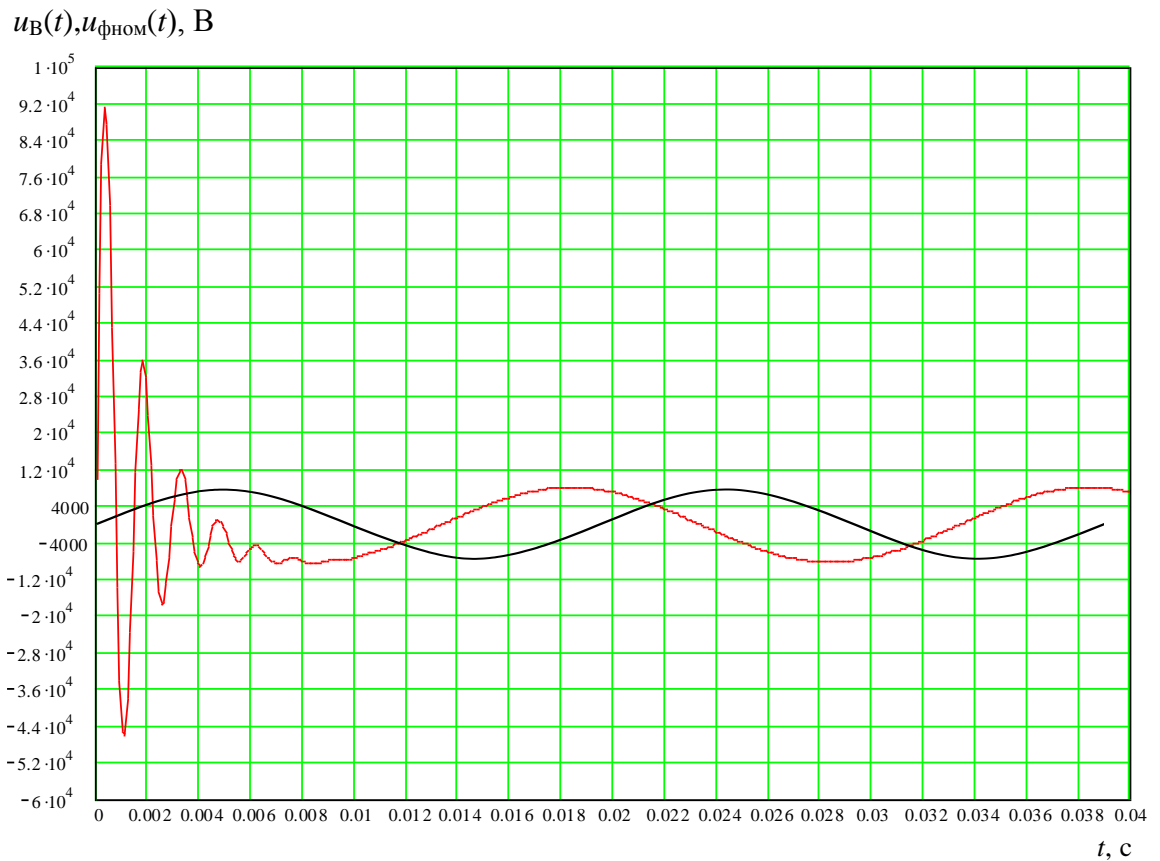
Рисунок 3.17 – Перенапряжения на фазе В секции шин ( \psi = 10^0, \varphi = 30^0, R_p = 5000 Ом, I_{ДГР} = 52 А)
