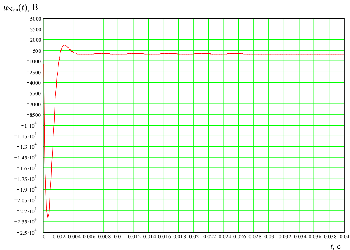
Рисунок 4.13 – Перенапряжения на дугогасящем реакторе ( \psi = 20^\circ, \varphi = 30^\circ, I_{ДГР} = 52 А, R_p = 500 Ом, C_{огр} = 0,25 мкФ на фазу)
