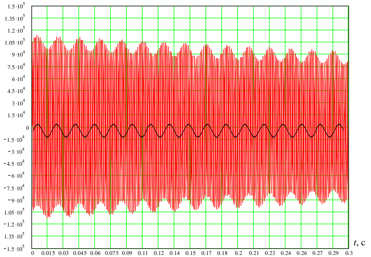
Рисунок 3.8 – Перенапряжения на фазе А секции шин ( \psi = 10^0, \varphi = 30^0, I_{\text{ДТР}}=52 \text{ А} )
