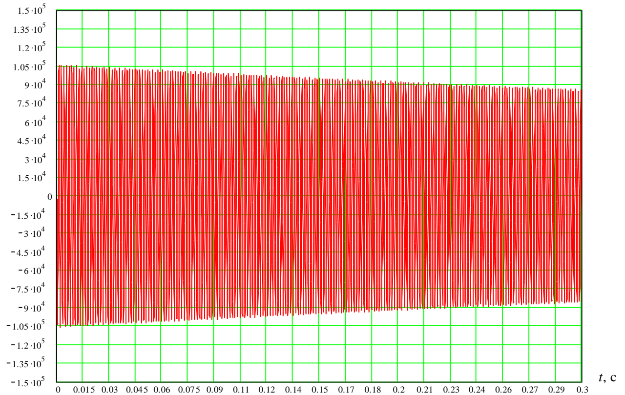
Рисунок 3.6 – Перенапряжения на дугогасящем реакторе ( \psi = 10^0, \varphi = 30^0, I_{\text{ДГР}} = 52 \text{ А} )
