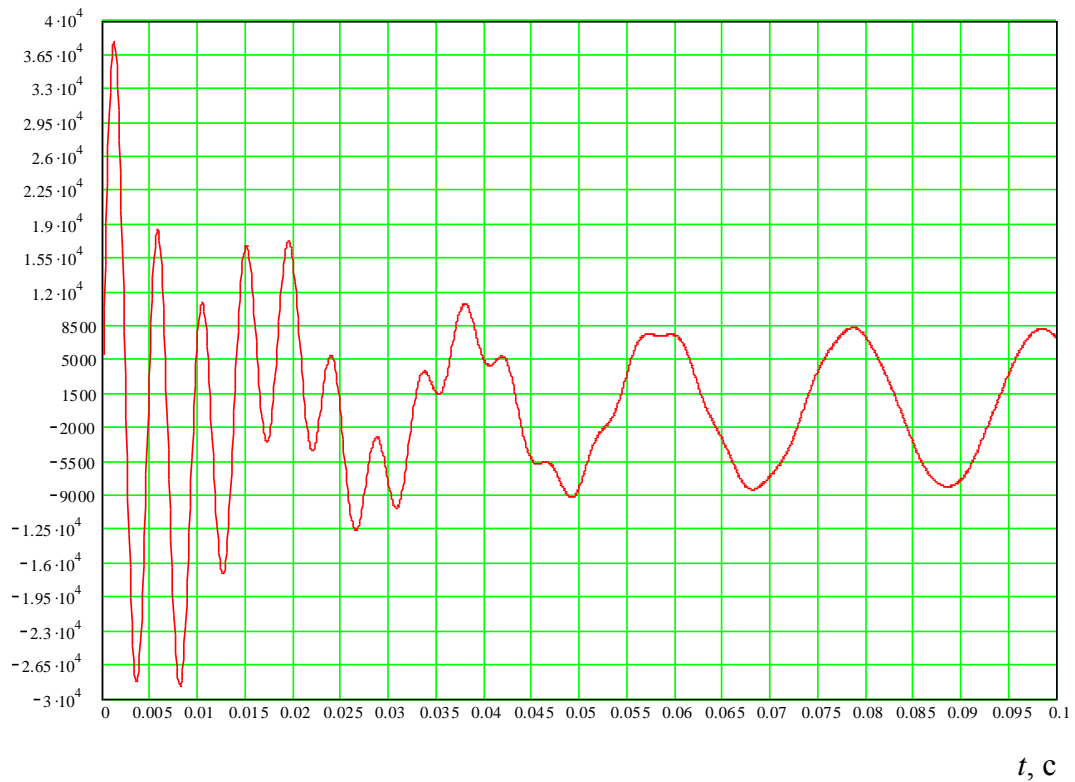
Рисунок П11.4 – Перенапряжения на фазе В секции шин ( \psi = 10^0 , \varphi = 0^0 , R_p = 5000 \text{ Ом} , I_{\text{ДГР}} = 52 \text{ А} )
