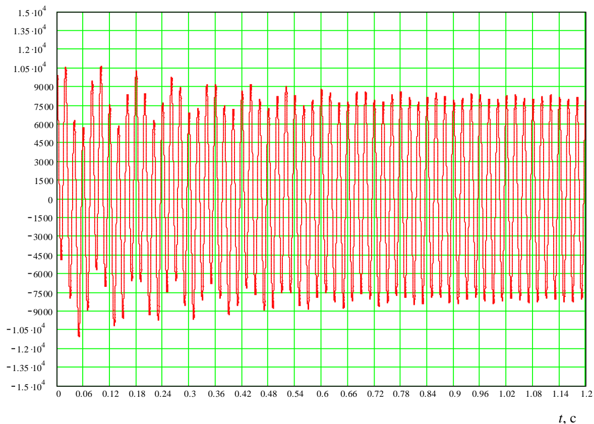
Рисунок 4.28 – Перенапряжения на фазе В секции шин ( \psi = 10^0, \varphi = 30^0, I_{\text{тр}} = 0,15 \text{ А} )
