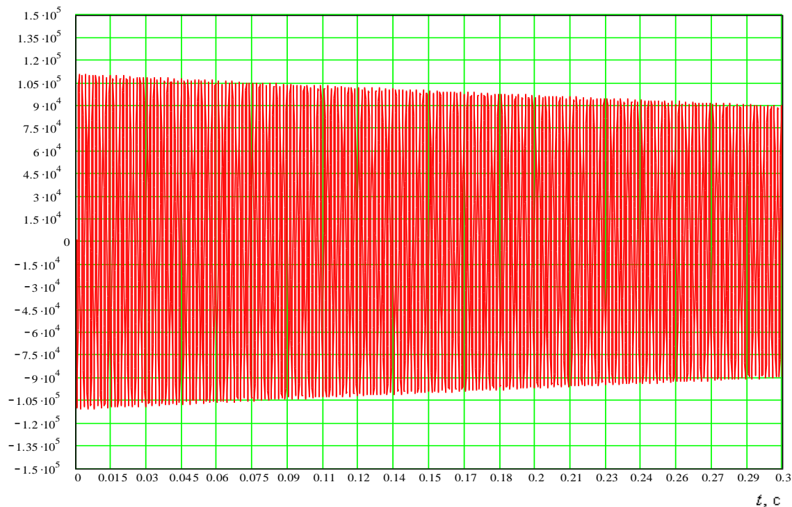
Рисунок ПЗ.1 – Перенапряжения на дугогасящем реакторе ( \psi = 10^0 , \varphi = 0^0 , I_{\text{ДГР}} = 52 \text{ А} )
