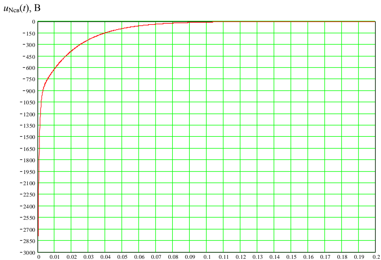
Рисунок 4.21 – Свободная составляющая напряжения смещения нейтрали при переходном процессе ( \psi = 10^0, \varphi = 30^0, R_p = 5000 \text{ Ом} )
