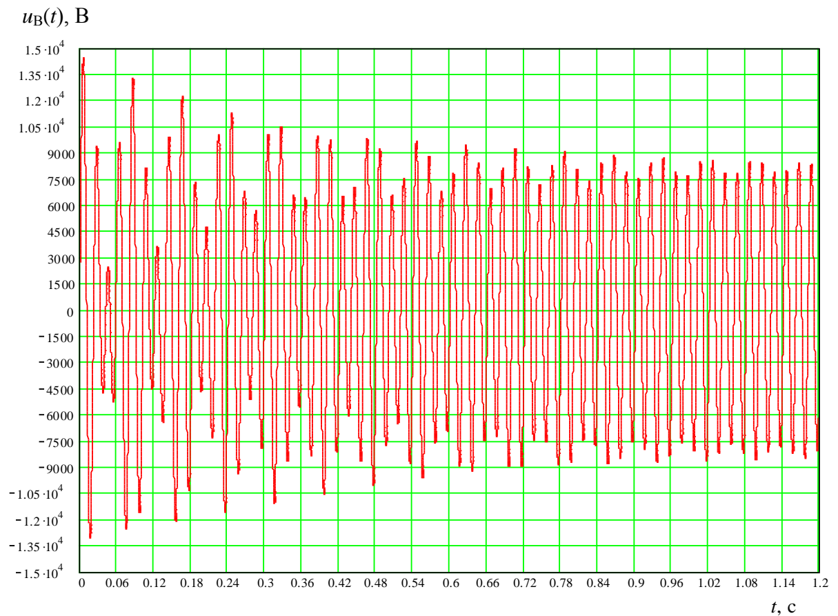
Рисунок 3.28 – Перенапряжения на фазе В секции шин ( \psi = 10^0, \varphi = 30^0, I_{\text{тр}} = 0,15 \text{ А} )
