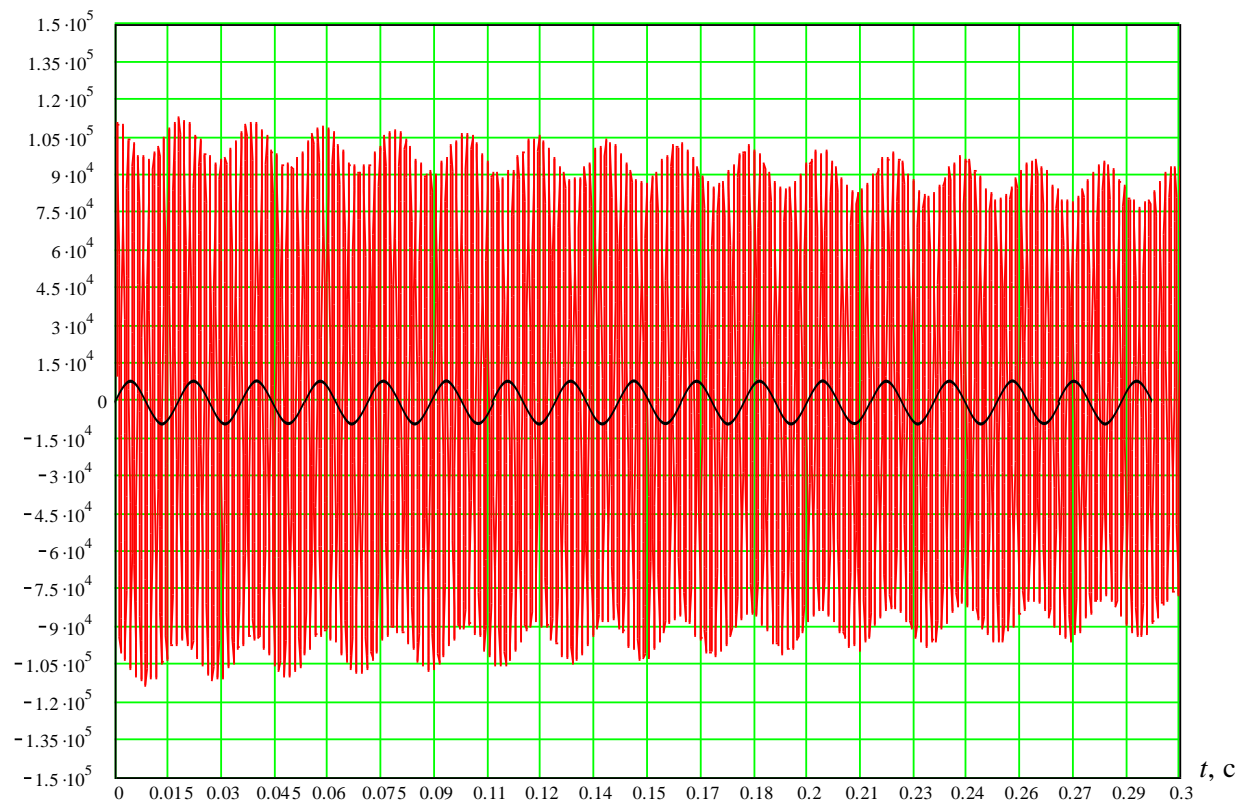
Рисунок 3.7 – Перенапряжения на фазе В секции шин ( \psi = 10^0, \varphi = 30^0, I_{\text{ДГР}} = 52 \text{ А} )
