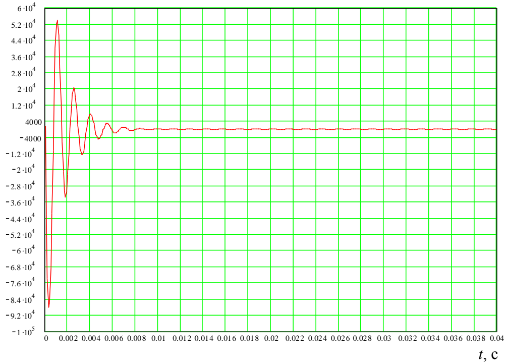
Рисунок П7.1 – Перенапряжения на дугогасящем реакторе ( \psi = 10^0 , \varphi = 0^0 , R_p = 5000 Ом, I_{ДГР} = 52 А)
