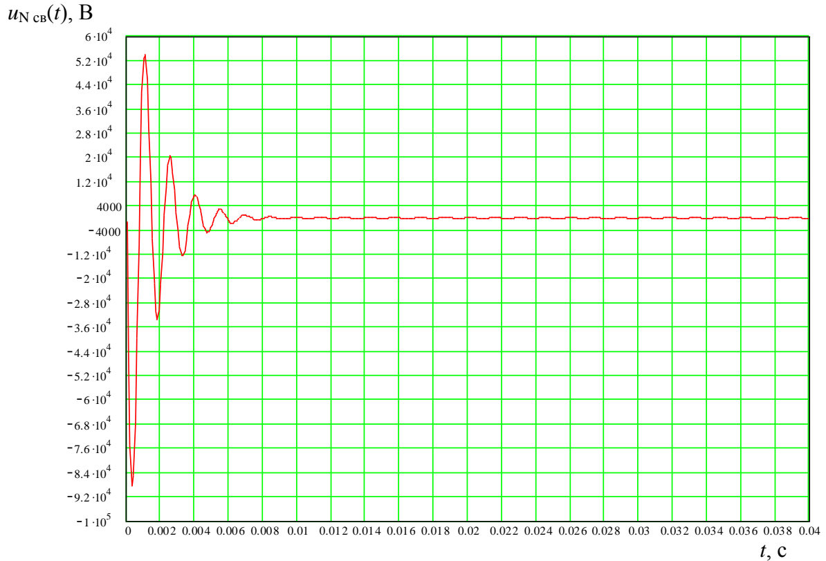
Рисунок П7.9 – Перенапряжения на дугогасящем реакторе ( \psi = 20^\circ , \varphi = 30^\circ , R_p = 5000 \text{ Ом} , I_{\text{ДГР}} = 52 \text{ А} )
