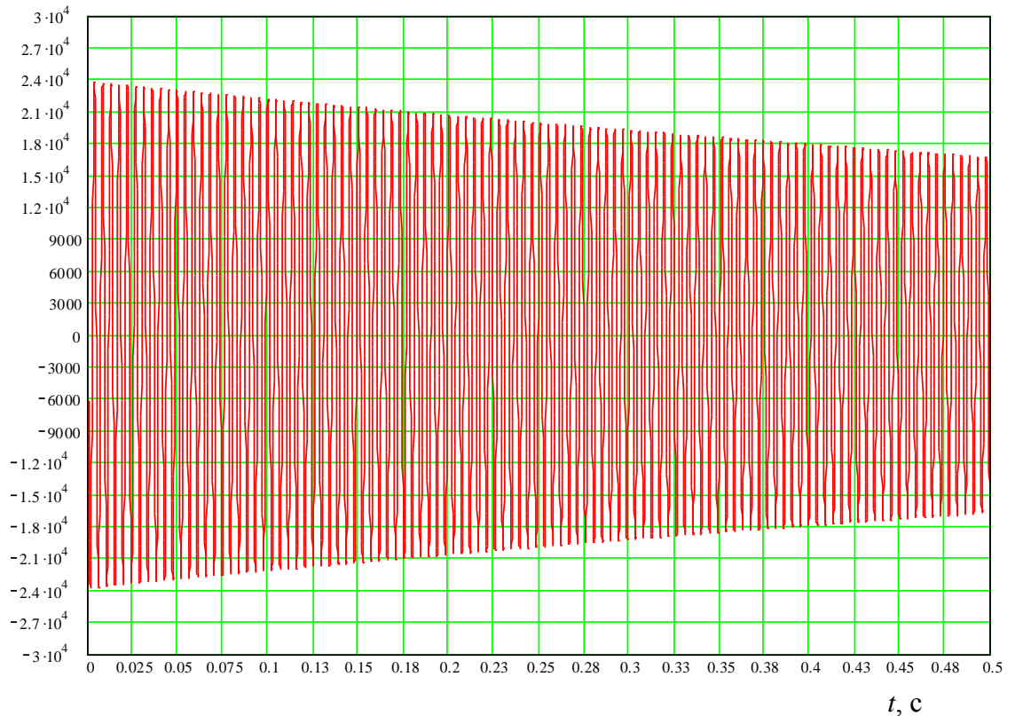
Рисунок П9.7 – Перенапряжения на дугогасящем реакторе ( \psi = 10^0 , \varphi = 60^0 , I_{\text{ДГР}} = 52 \text{ А} )
