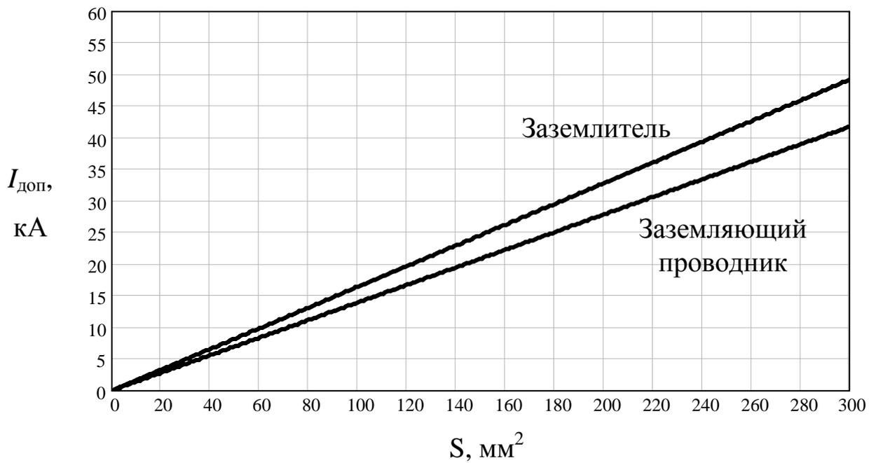
Рис. Ж.1 Допустимый ток КЗ для стальных проводников горизонтального заземлителя и заземляющего проводника, подсоединенного к аппарату, при времени воздействия не более 0,1 с
