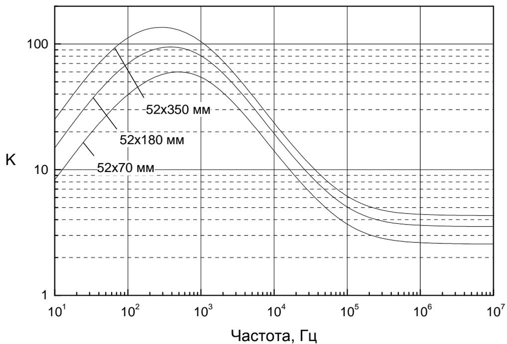
Рис. 3.8 Коэффициенты экранирования стальных коробов различного сечения
