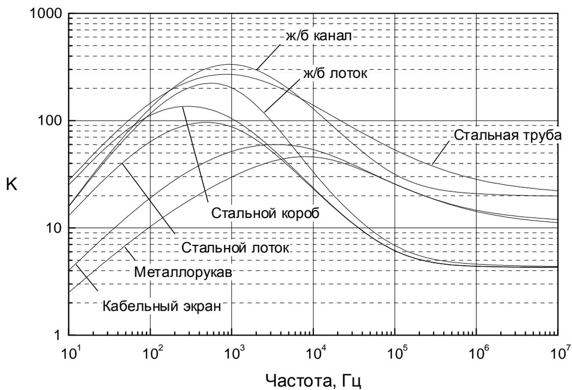
Рис. 3.3 Сравнительные коэффициенты экранирования различных экранирующих элементов
