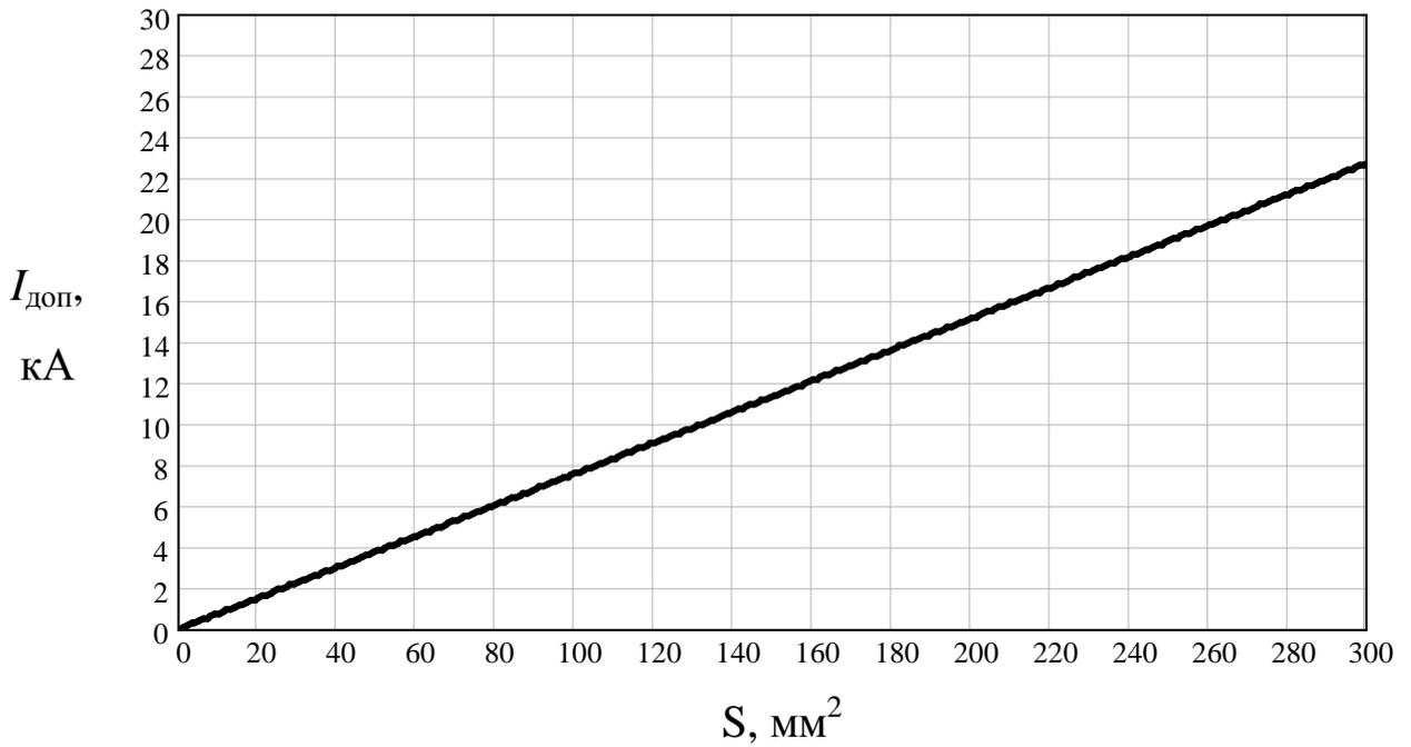
Рис. Ж.3 Допустимый ток КЗ для арматуры железобетона при времени воздействия не более 0,1 с
