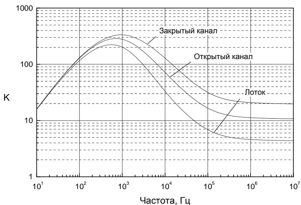
Рис.3.9 Коэффициенты экранирования железобетонных каналов и лотков (при обеспечении непрерывности электрического соединения)
