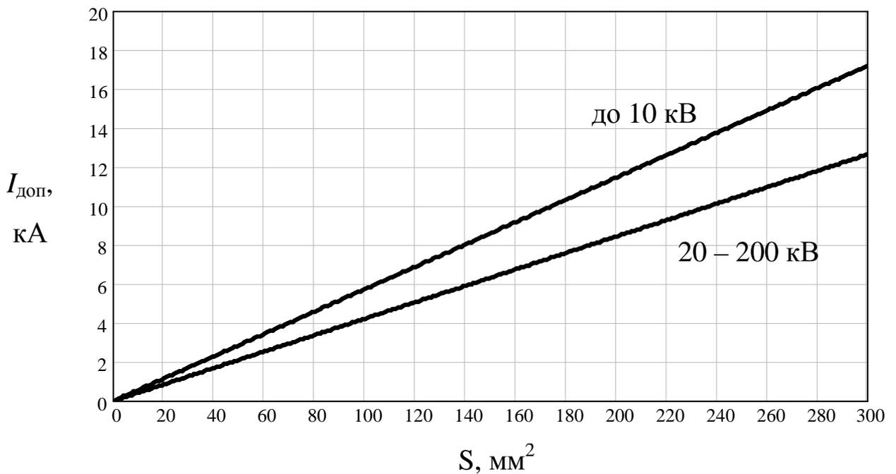
Рис. Ж.4 Допустимый ток КЗ для свинцовой оболочки кабелей с бумажной пропитанной изоляцией на напряжение до 10 кВ и (20 - 200) кВ при времени воздействия не более 0,1 с.
