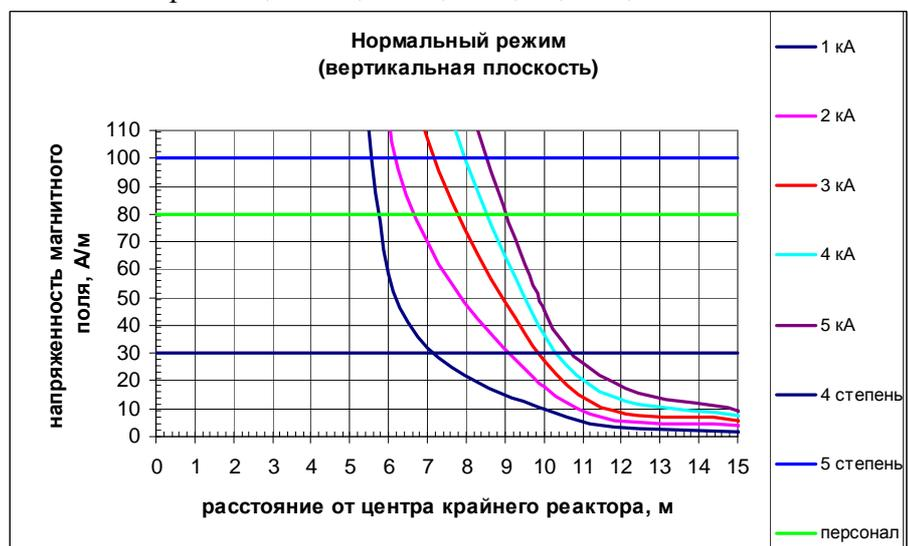
Рис.В.30 Распределение НМП при нормальных режимах в вертикальной плоскости при  $Z=0,96$  Ом;  $n=45$ ;  $R=0,9$ м;  $S=2,4$ м
