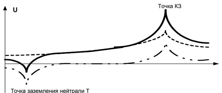
Рис. 4 Распределение потенциалов на заземляющем устройстве
