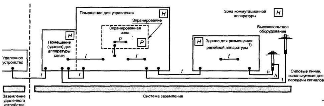
Рис.Б.2 Виды соединений на подстанции
