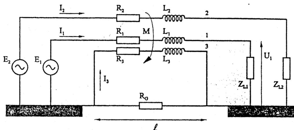
Рис. 3.2 Схема замещения для расчета коэффициента экранирования.
