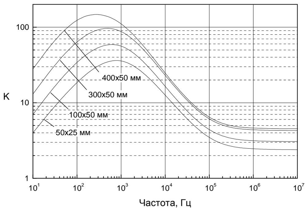
Рис.3.7 Коэффициенты экранирования стальных лотков различного сечения
