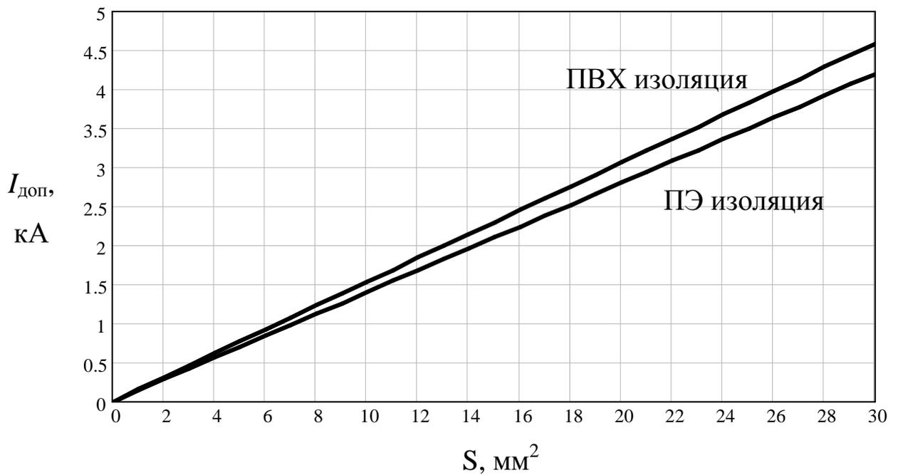
Рис. Ж.6 Допустимый ток КЗ для алюминиевого экрана кабеля с поливинилхлоридной или резиновой изоляцией и полиэтиленовой изоляцией при времени воздействия не более 0,1 с
