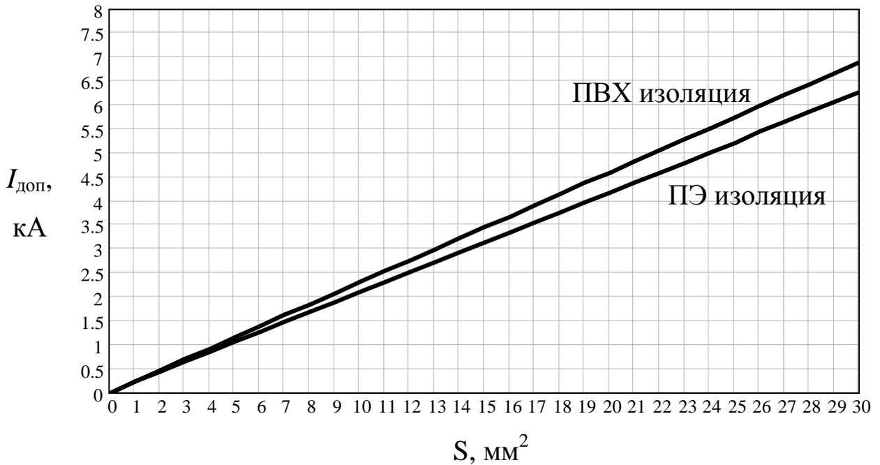
Рис. Ж.7 Допустимый ток КЗ для медного экрана кабеля с поливинилхлоридной или резиновой изоляцией и полиэтиленовой изоляцией при времени воздействия не более 0,1 с.
