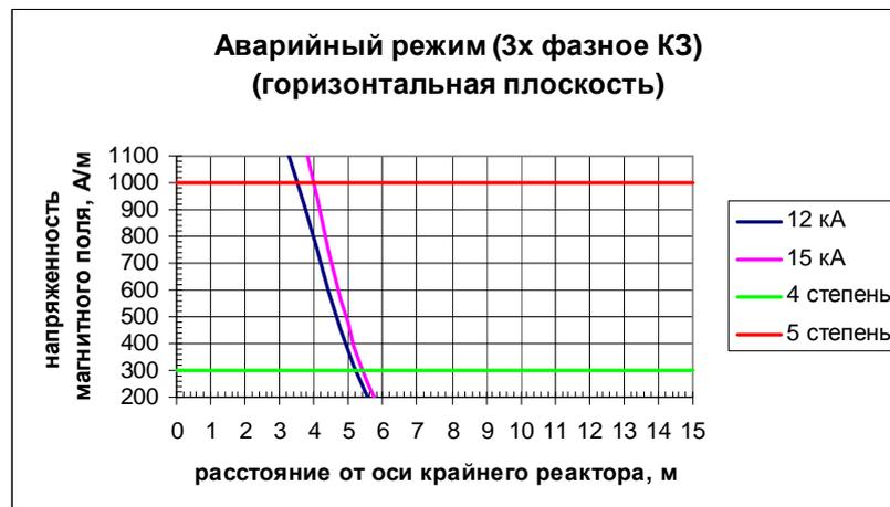
Рис.В.17 Распределение НМП при аварийных режимах в горизонтальной плоскости при  $Z=0,25$  Ом;  $n=34$ ;  $R=0,6$ м;  $S=2,4$ м
