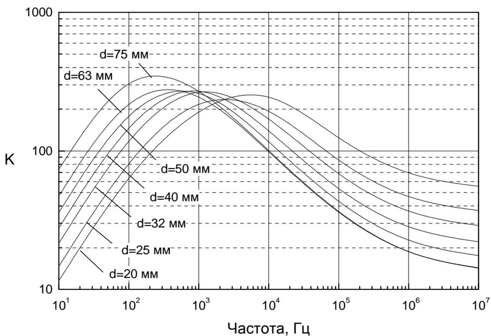
Рис.3.6 Коэффициенты экранирования стальных толстостенных труб различного диаметра
