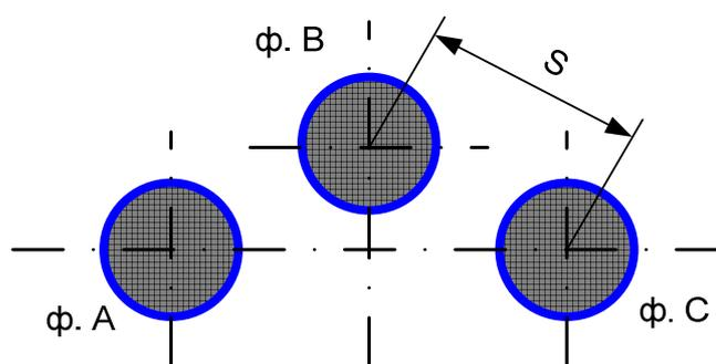
Рис.В.3 Расположение реакторов в вершинах тупогольного равнобедренного треугольника
