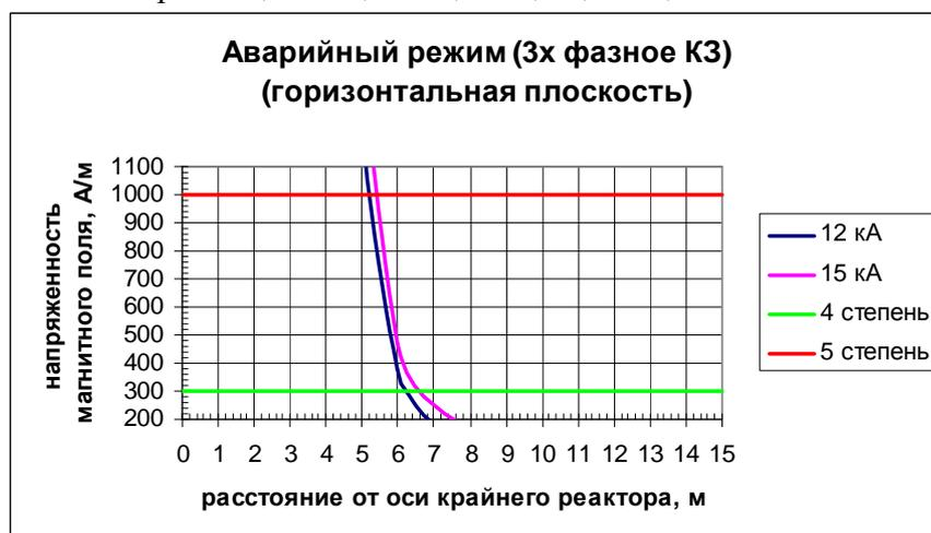
Рис.В.31 Распределение НМП при аварийных режимах в горизонтальной плоскости при  $Z=0,96$  Ом;  $n=45$ ;  $R=0,9$ м;  $S=2,4$ м
