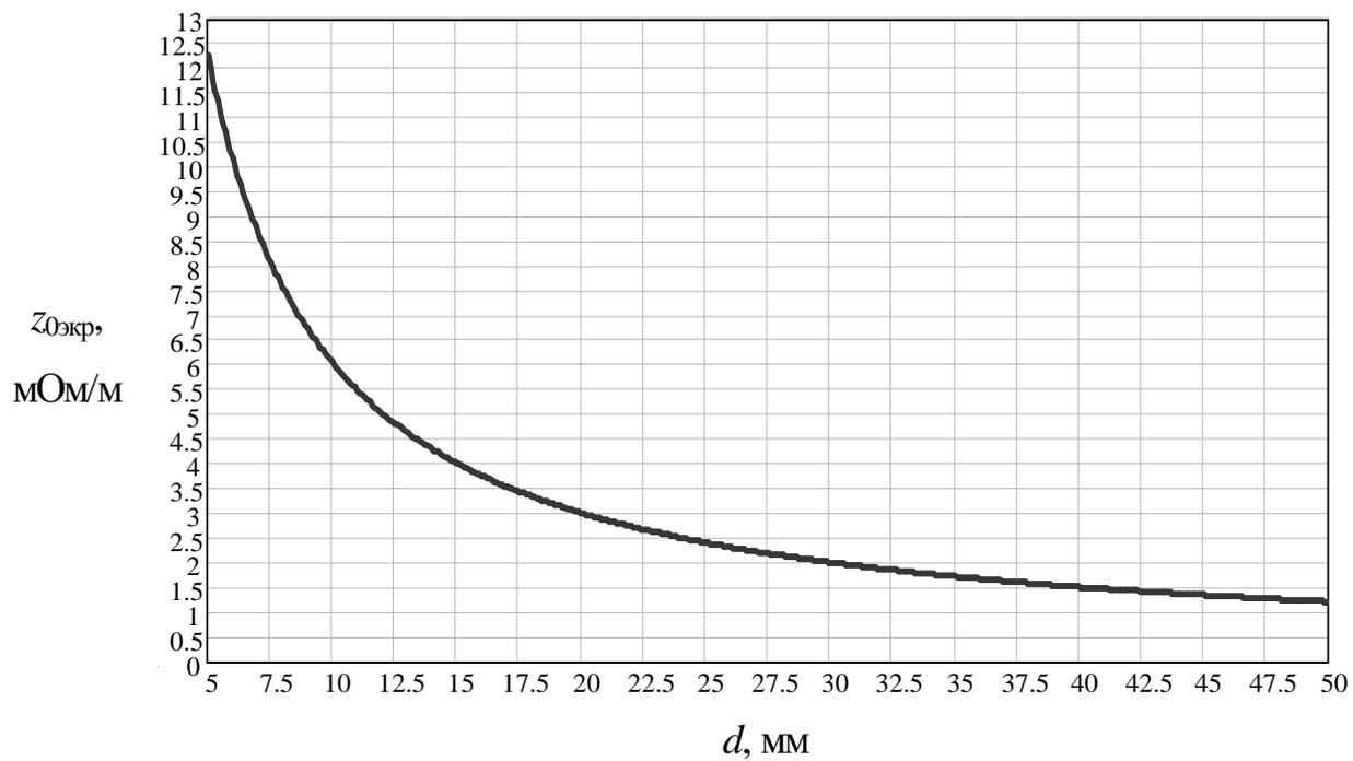
Рис. Ж.11 Зависимость погонного сопротивления алюминиевого экрана  $z_{0\text{экp}}$  от его наружного диаметра  $d$
