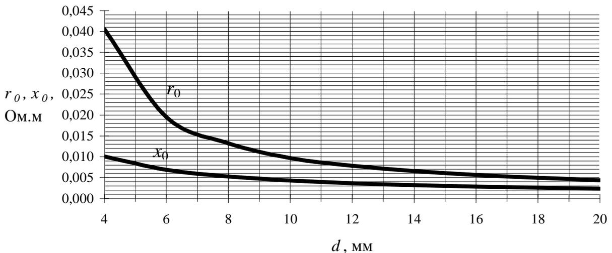
Рис. Ж.8 Зависимость погонных активного  $r_0$  и индуктивного  $x_0$  сопротивлений стального проводника от диаметра  $d$
