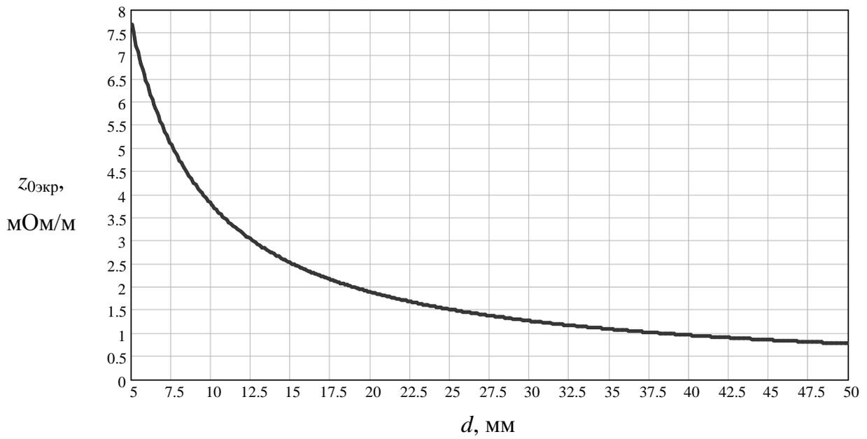
Рис. Ж.10 Зависимость погонного сопротивления медного экрана  $z_{0экp}$  от его наружного диаметра  $d$
