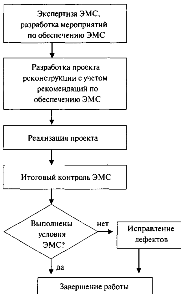
Рисунок А. 1 - Алгоритм организации работ по обеспечению ЭМС ТС при реконструкции существующего объекта
