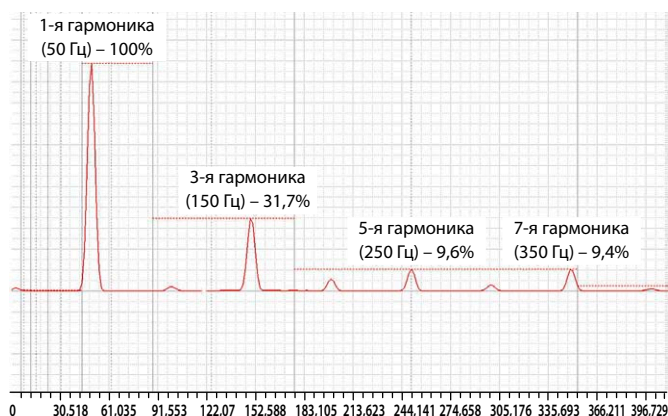
• Рис. 11 Событие 30.01.2017 в 01:01:58 Металлическое замыкание фазы С. Спектрограмма гармонических составляющих тока реактора I_p
